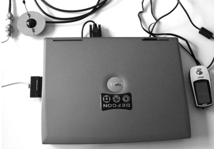
Figuur 2 (Typische War Driving opstelling met laptop, antenne en GPS)
